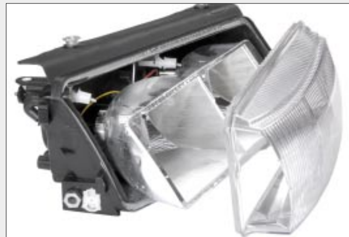
Die gerissenen Reflektoraufhängungen des Testkandidaten sind deutlich zu erkennen.
